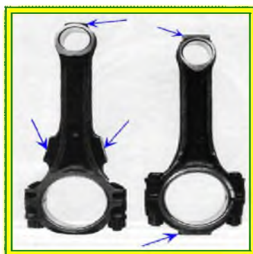
Рисунок 2. Стрелками отмечены бобышки, с которых снимается часть металла
