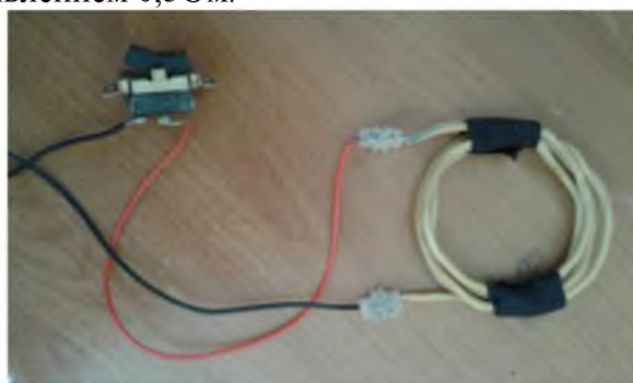
Рисунок 27. Нагрузка для трансформатора
