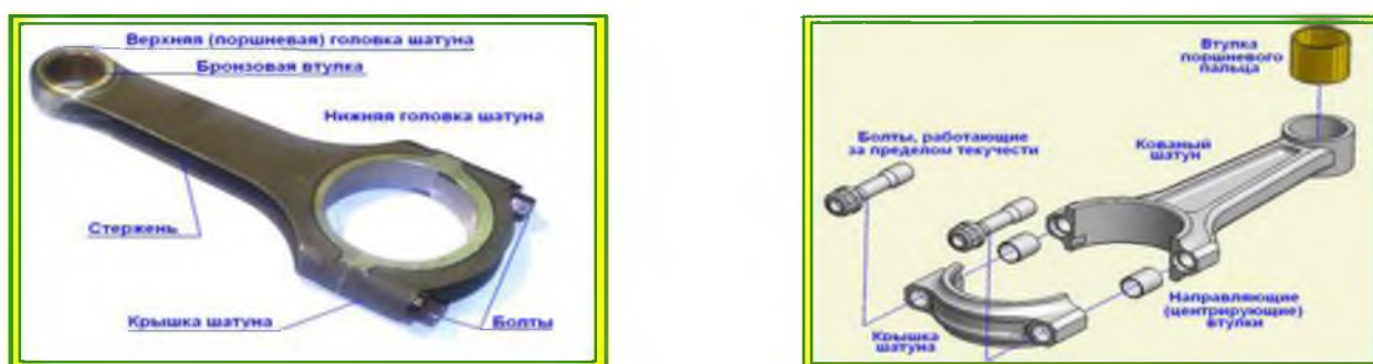
Рисунок 1. Общий вид и эскиз сборки шатуна
