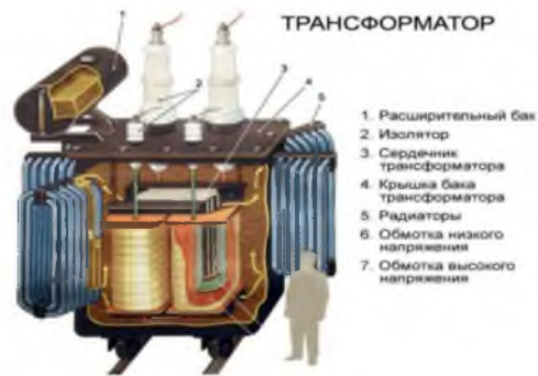
Рисунок 23. Схема устройства масляного трансформатора [13]
