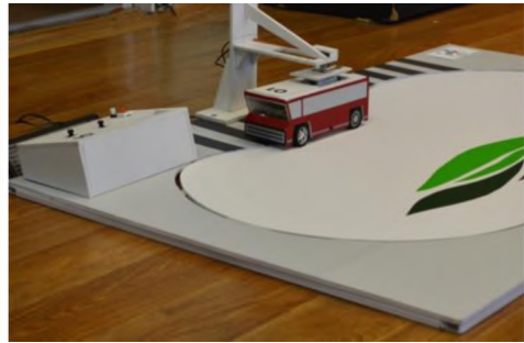
Рис.12. Общий вид модели электромобиля на ионисторах. Подзарядка электромобиля на автобусной остановке
