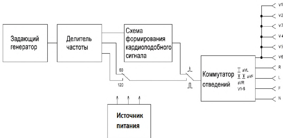
Рисунок 3 – Структурная схема прибора для проверки работы кардиографа
