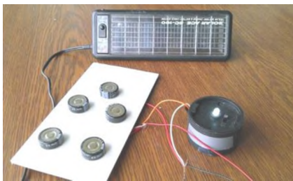
Рисунок 4 – Зарядка ионисторов от солнечной батареи
