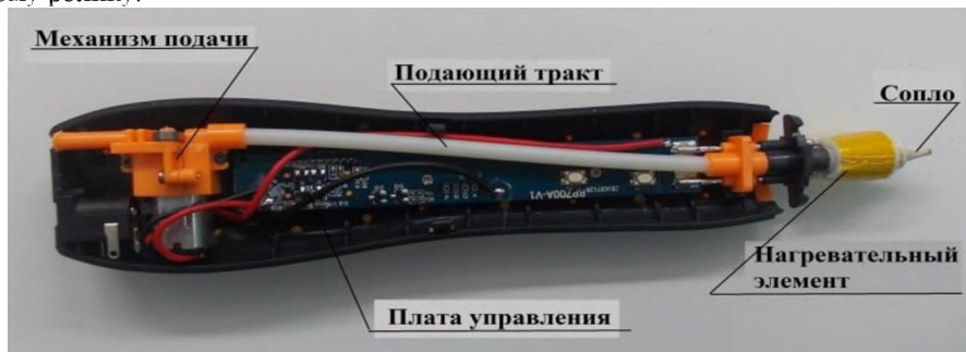
Рисунок 1 – Устройство 3D ручки «Rovermate 3D art»
