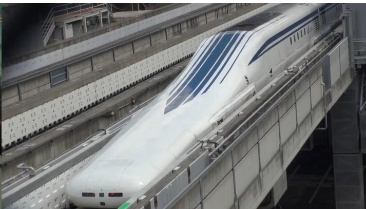
Рис. 9. Новейший Маглев L0 в Японии имеет пять вагонов и достигает скорости 500 км/ч
