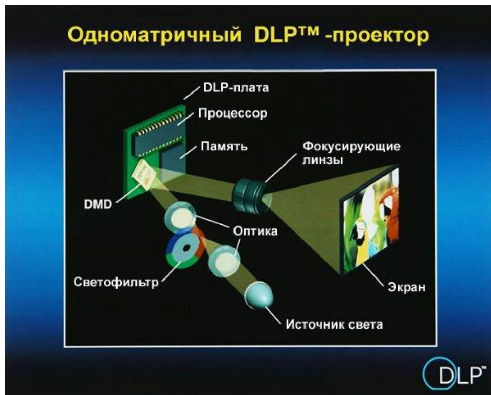
Рис.9. Схема работы одноматричного DLP-проектора.
